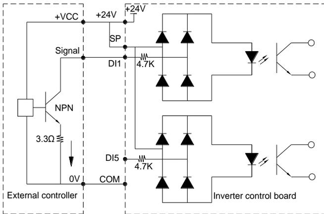
Fig.2-6.3 Drain wiring mode
