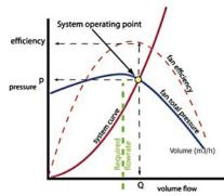
هرفن منحنی عملکرد ویژه خود را دارد ، که بستگی به نوع فن ، شکل پروانه ، تعداد پروانه ها و مشخصات موتور آن دارد.برای مشخص کردن نقطه عملکرد فن ، ابتدا فشار استاتیک را محاسبه کرده و سپس مقدار آن را در محور سمت چپ مشخص کنید. یک خط افقی از این مقدار فشار رسم کرده و تقاطع آن را با منحنی عملکرد تعین کنید. حال یک خط عمودی از نقطه تقاطع تا محور افقی پایین رسم کنید تا مقدار هوادهی در آن فشار معین بدست آید.
