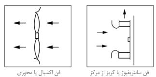
با توجه به ایجاد فشار استاتیکی بالا و شکل دهانه خروجی، این فن ها قابلیت اتصال به شبکه کانال کشی را دارند. از این رو در پروژه هایی که شبکه کانال کشی و یا سایر تجهیزات معمول تهویه هوا مانند فیلتر وجود دارد، از فن های سانتریفیوژ جهت غلبه بر این فشار استفاده می گردد .
