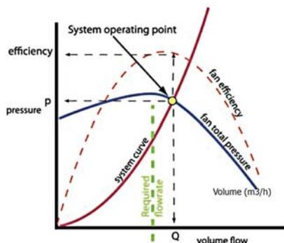
هر فن منحنی عملکرد ویژه خود را دارد ، که بستگی به نوع فن ، شکل پروانه ، تعداد پروانه ها و مشخصات موتور آن دارد. برای مشخص کردن نقطه عملکرد فن ، ابتدا فشار استاتیک را محاسبه کرده و سپس مقدار آن را در محور سمت چپ مشخص کنید. یک خط افقی از این مقدار فشار رسم کرده و تقاطع آن را با منحنی عملکرد تعیین کنید. حال یک خط عمودی از نقطه تقاطع تا محور افقی پایین رسم کنید تا مقدار هوادهی در آن فشار معین بدست آید .
