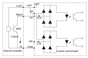
Fig.2-6.3 Drain wiring mode
