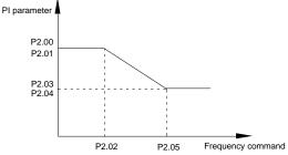
Fig.5-2PI parameter schematic diagram
