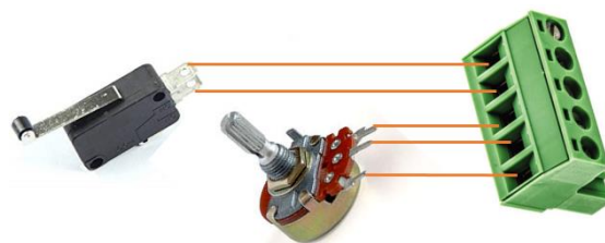
شکل ۴: اتصال پتانسومتر خارجی و میکرو سوئیچ به درایور
